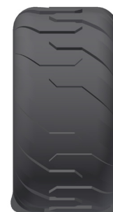
Falta de pressão
